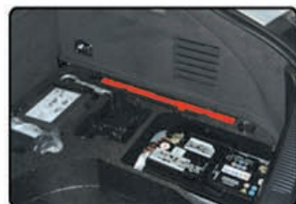
дополнительная плата реле под обивкой багажного отсека
